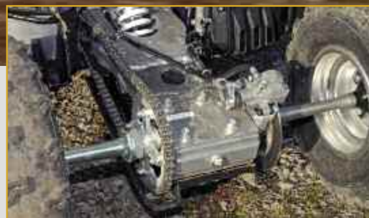
Stabil: Geschweißte Aluschwinge
