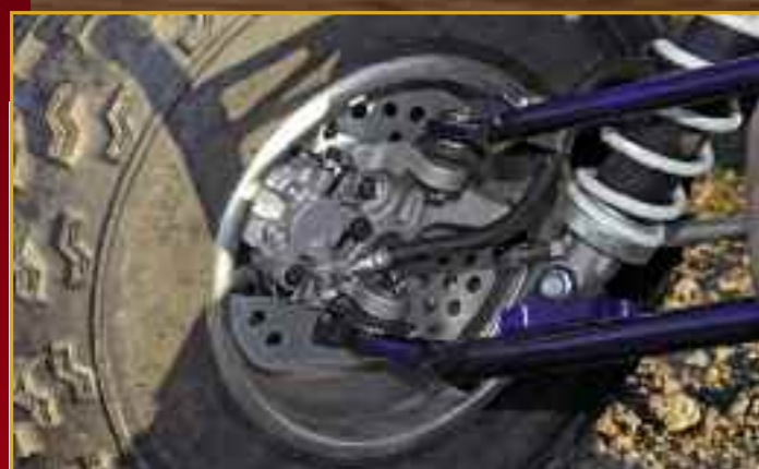
Geschützt: Eine Blechabdeckung hält Schmutz wirksam von der Bremse fern
