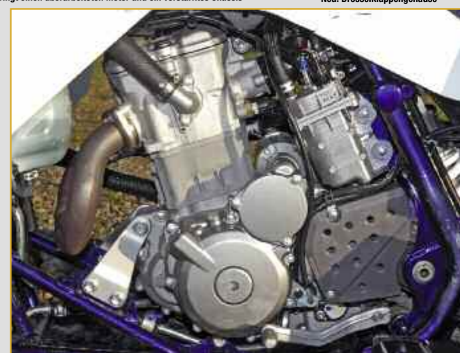
Kräftig: Der 400er Einzylinder legt dank EFI im unteren und mittleren Drehzahlbereich zu
